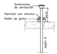
DETALLE 1: REMATE VENTILACIÓN EN CUBIERTA Esc.1:20
