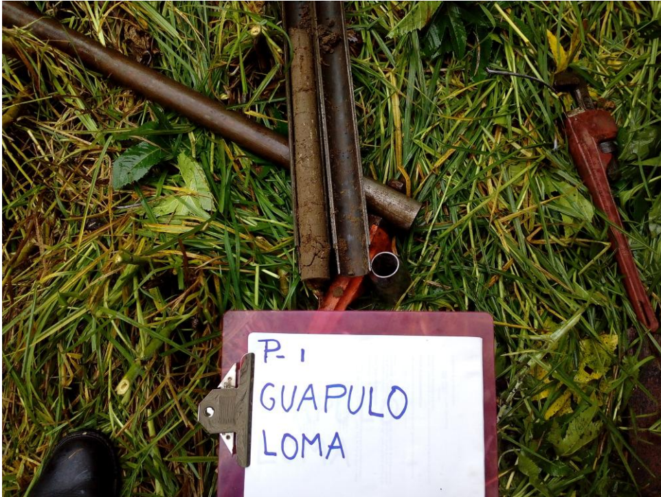
SONDEO P-1, MUESTRA TUBO PARTIDO, PROF. 1.00-1.50m., RELLENO
