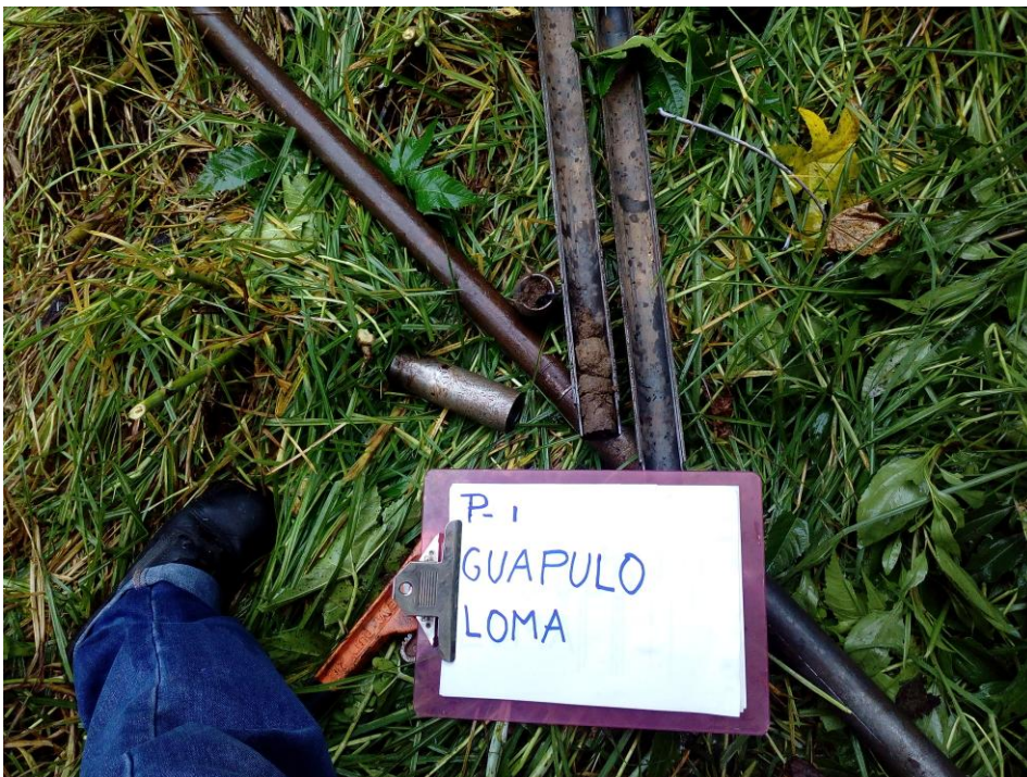
SONDEO P-1, MUESTRA TUBO PARTIDO, PROF. 0.50-1.00m., RELLENO.
