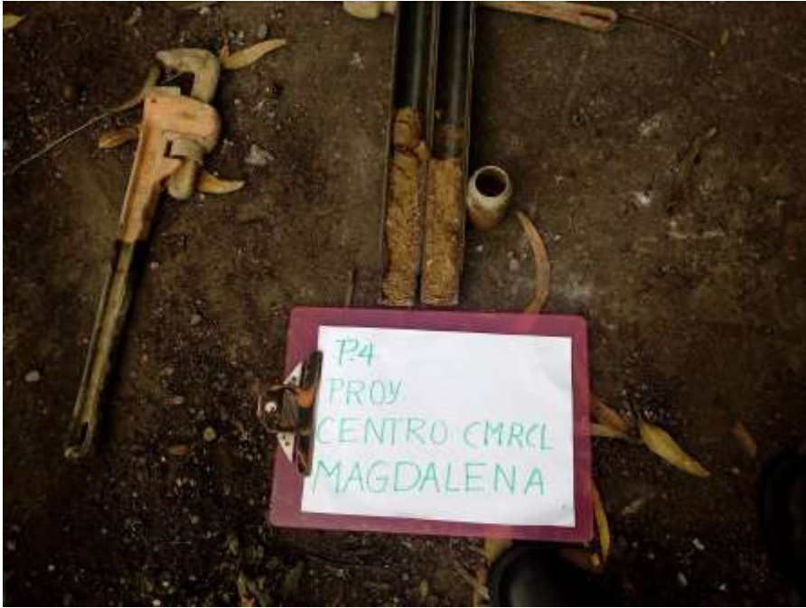
.SONDEO P-4, MUESTRA EN TUBO PARTIDO, PROF. 0.50-1.00 m.,
