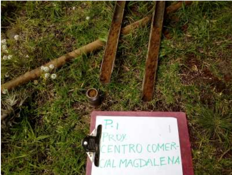
SONDEO P-1, MUESTRA EN TUBO PARTIDO, PROF. 1.00-1.50 m.,
