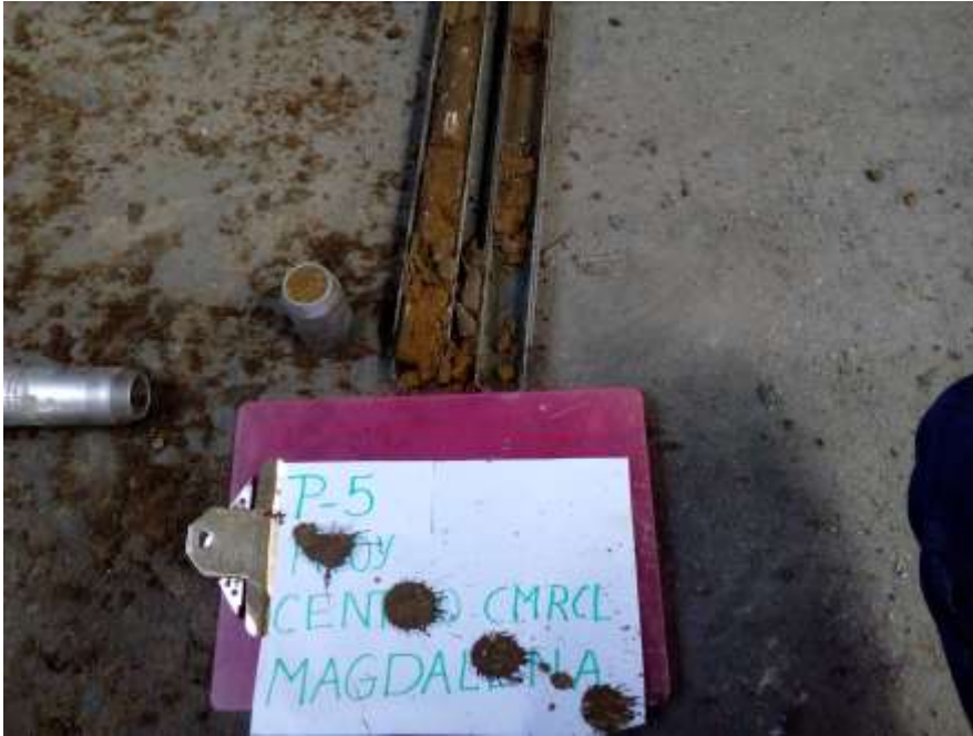
SONDEO P-5, MUESTRA EN TUBO PARTIDO, PROF. 1.00-1.50 m.,
