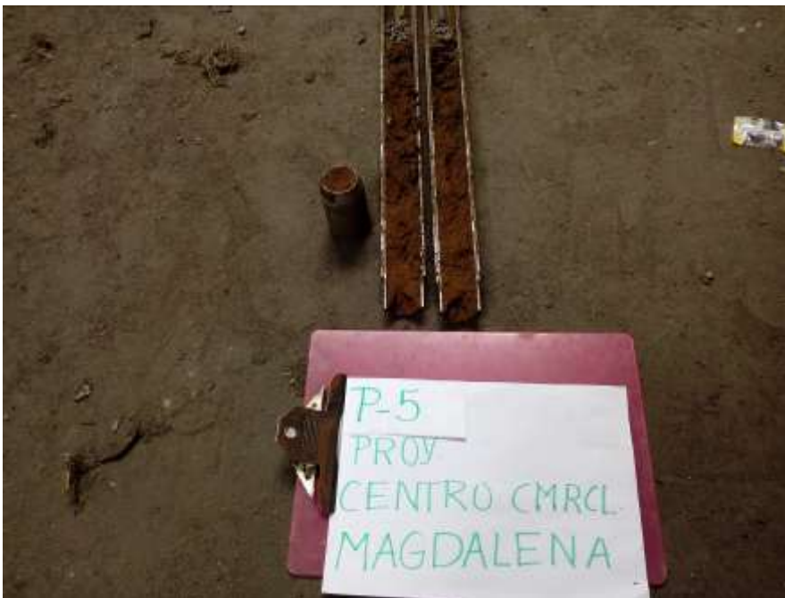
SONDEO P-5, MUESTRA EN TUBO PARTIDO, PROF. 0.50-1.00 m.,
