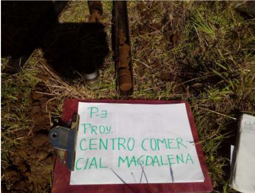
SONDEO P-3, MUESTRA EN TUBO PARTIDO, PROF. 1.00-1.50 m.,
