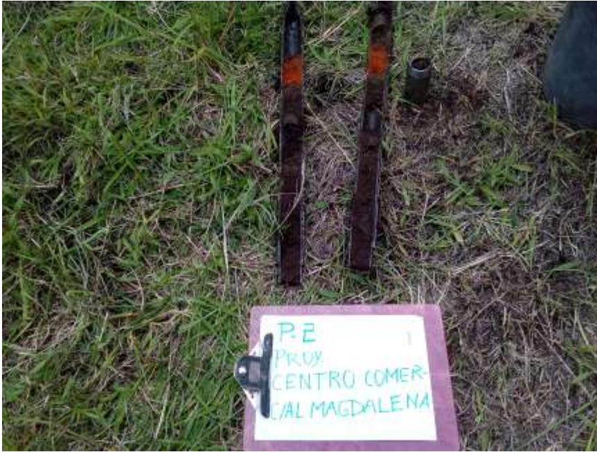
SONDEO P-2, MUESTRA EN TUBO PARTIDO, PROF. 0.50-1.00 m.,
