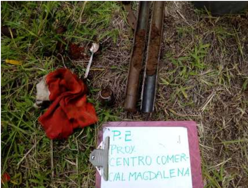
SONDEO P-2, MUESTRA EN TUBO PARTIDO, PROF. 1.00-1.50 m.,
