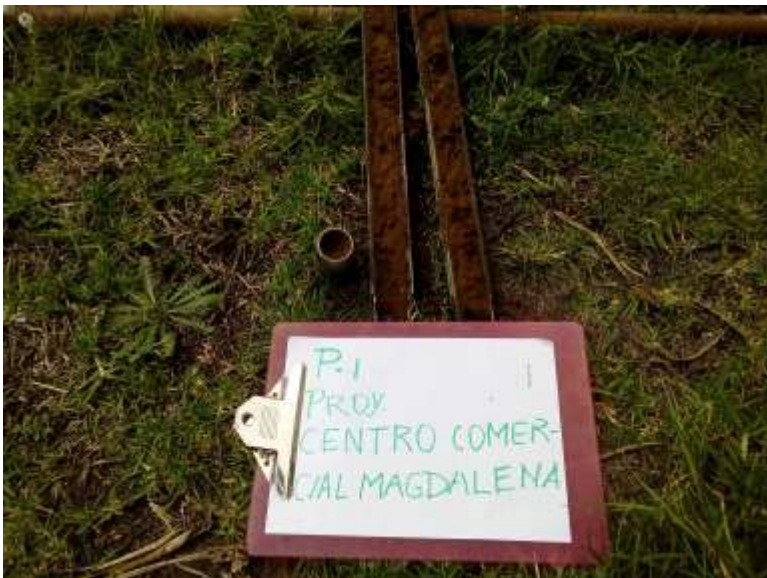
SONDEO P-1, MUESTRA EN TUBO PARTIDO, PROF. 0.50-1.00 m.,
