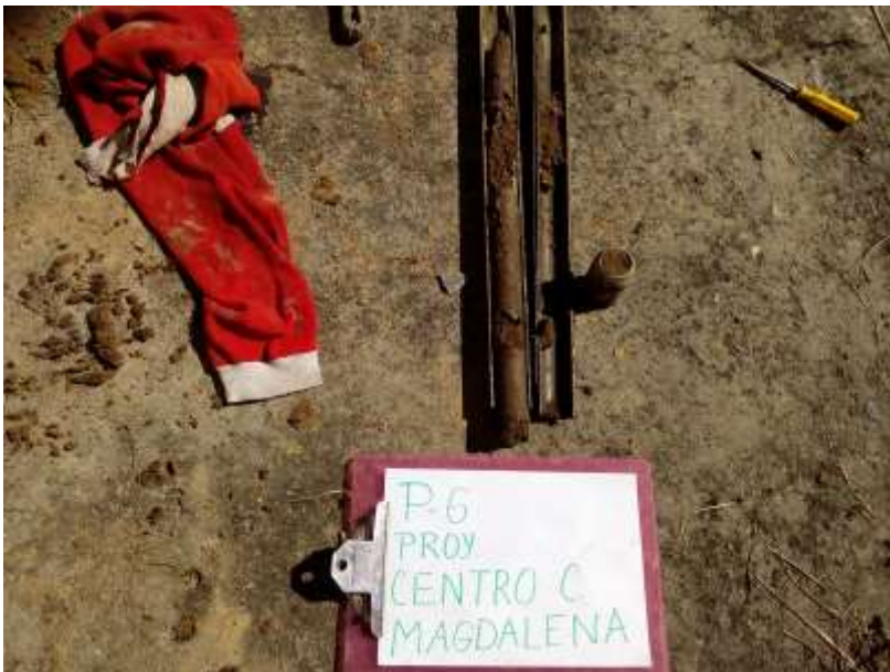
SONDEO P-6, MUESTRA EN TUBO PARTIDO, PROF. 1.00-1.50 m.,
