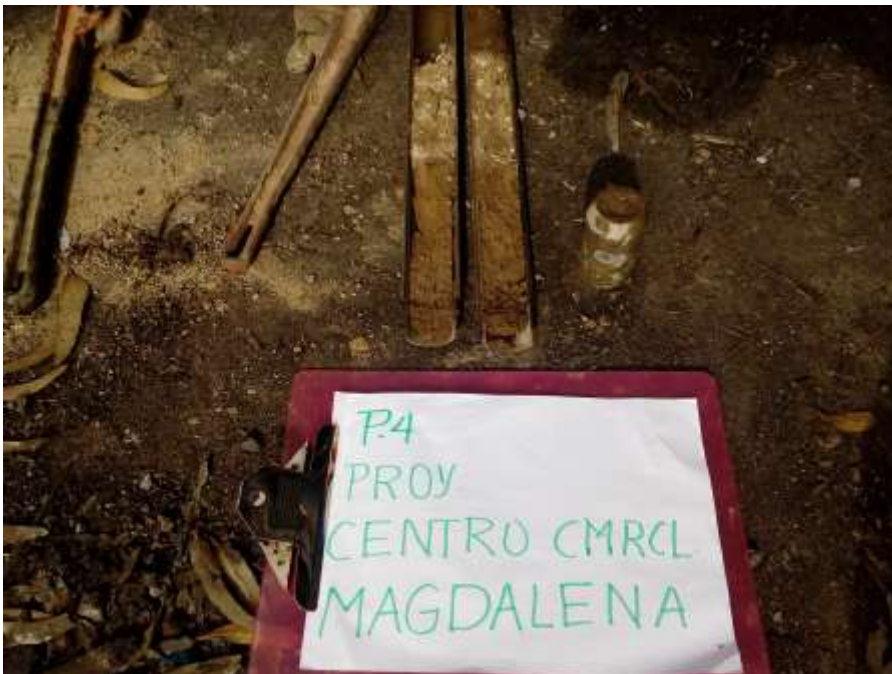
SONDEO P-4, MUESTRA EN TUBO PARTIDO, PROF. 1.00-1.50 m.,
