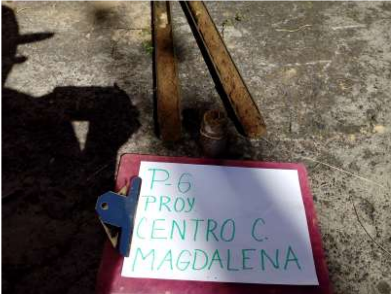
SONDEO P-6, MUESTRA EN TUBO PARTIDO, PROF. 0.50-1.00 m.,
