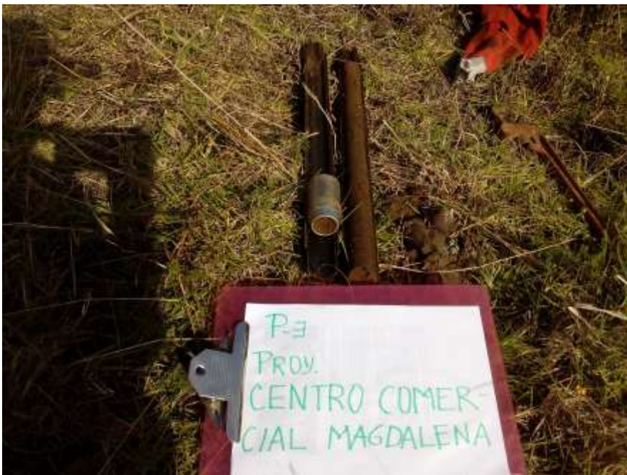
SONDEO P-3, MUESTRA EN TUBO PARTIDO, PROF. 0.50-1.00 m.,
