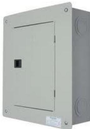
El tablero debe ser de norma NEMA 1 para usos generales, fabricado con lámina de acero estirado en frío, previo tratamiento de fosfatizado en caliente, curado al horno y terminado con pintura en polvo beige duna; estos procesos aseguran la dureza y acabados adecuados. Todos los gabinetes deben incluir un número suficiente de “knockouts” o discos removibles de diferentes diámetros para tubería, cubriendo así cualquier posición deseada para los tubos de acceso y salida de cables.
