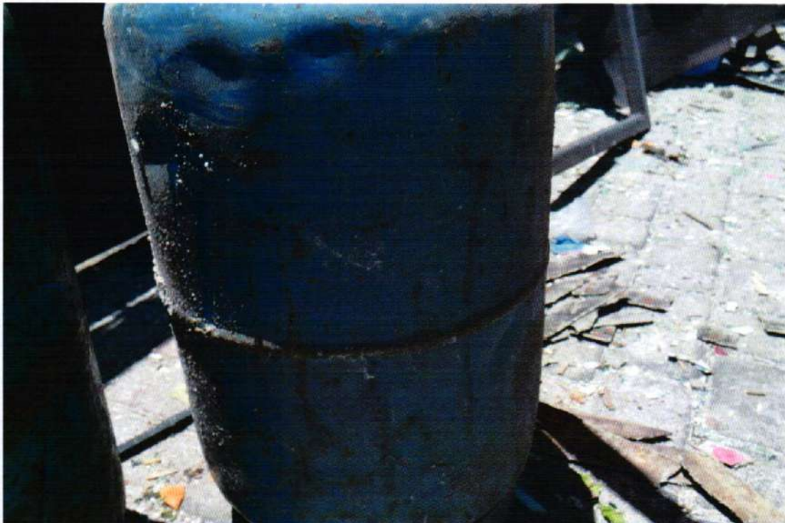
Fotografía 13: Cilindro de gas LP extraído de local de venta de comida, presenta escarcha o congelamiento externo.
