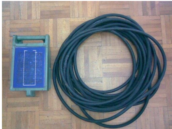
GRÁFICO 2. Contador automático y tubos neumáticos utilizados
