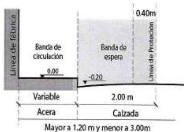
Esquema 006: Dimensiones mínimas de bandas de circulación y espera.
