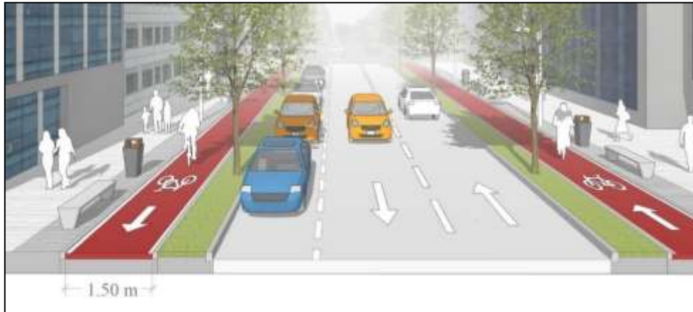
Figura 10. Carril Segregado Fuente: (Municipalidad de Lima, 2017)
