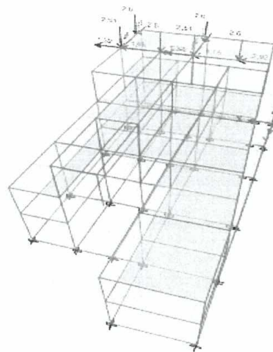
Figura N° 7. APLICACIÓN DE REACCIONES DE MASTILES
