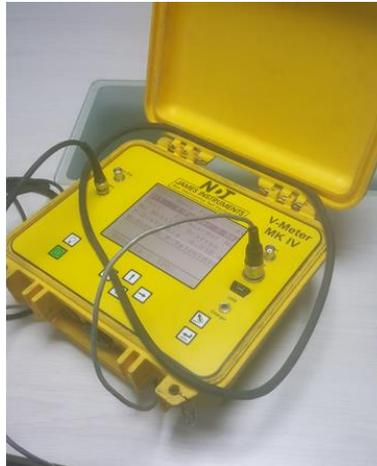
**Figura N° 21 Equipo de Ultrasonido**
