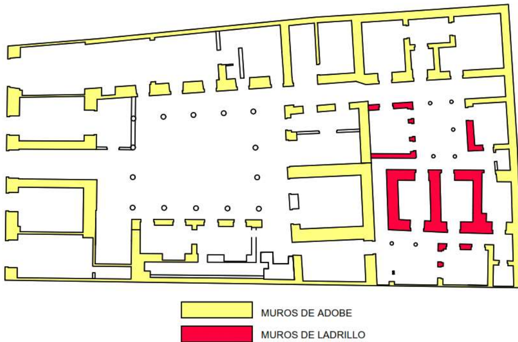
Figura 1 MUROS ESTRUCTURALES PLANTA BAJA
