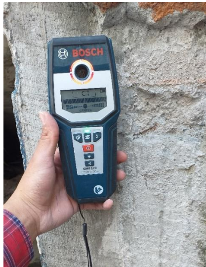
Fotografía 2. Escáner de acero de refuerzo.
