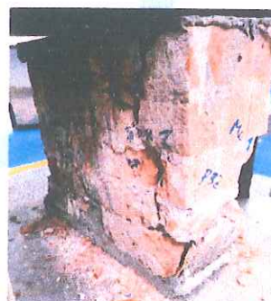
Figura 6. Esquema de Falla - Probeta No. 6
