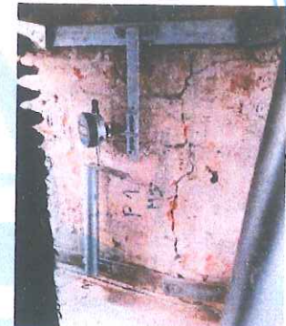
Figura 2. Esquema de Falla Probeta No. 2
