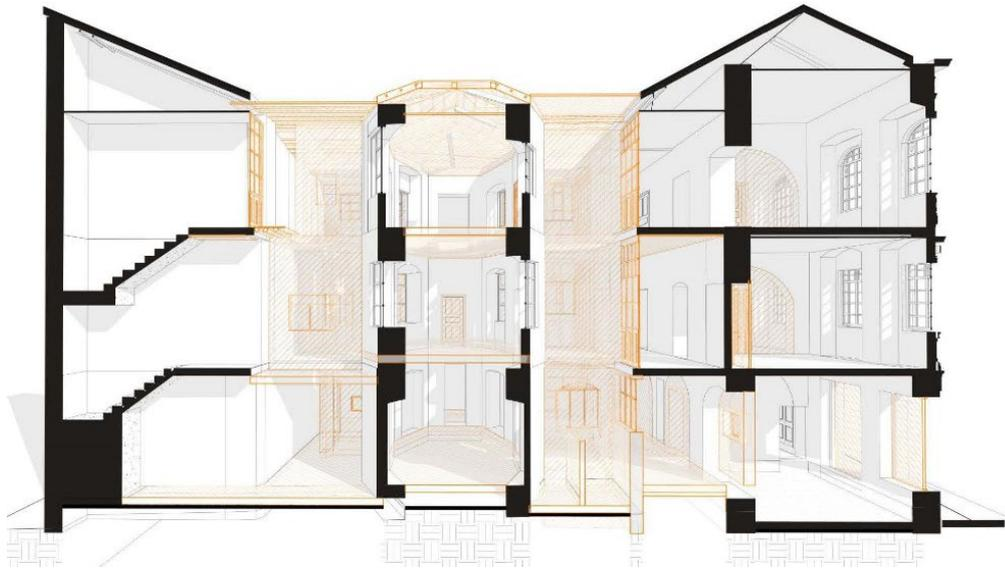
Figura 27: Demolición de muros añadidos y otros añadidos sin valor.
