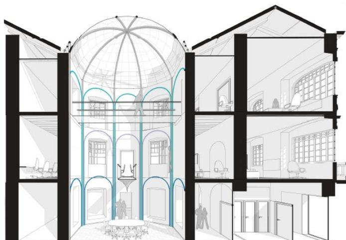
Figura 16. Inserción de cubierta en cuerpo central.
