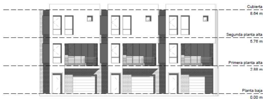
Imagen 7. Fachada Principal Fuente: Planos arquitectónicos
