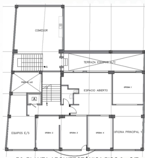
P2. PLANTA ARQUITECTÓNICA PISO 2 – S/E
