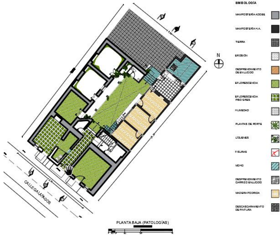
Imagen N° 07. Patologías Planta Baja • Fuente: Ilustración Propia
