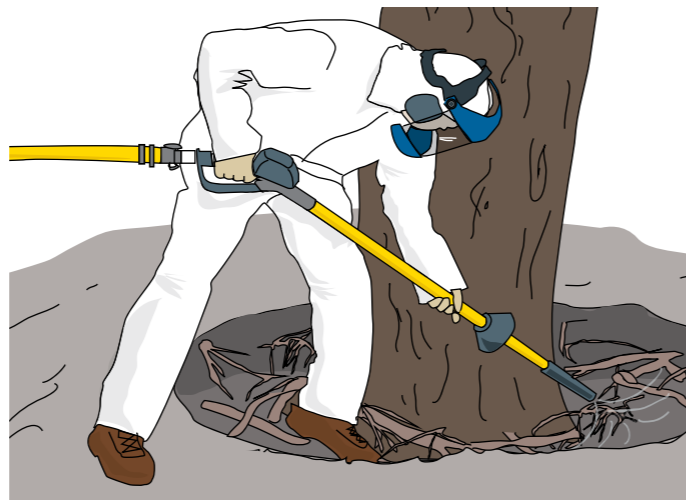
FIGURA 10. Uso de pala de aire.
