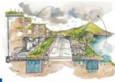
FIG. 22. Infiltración en parterres con el uso de zanjas de infiltración
