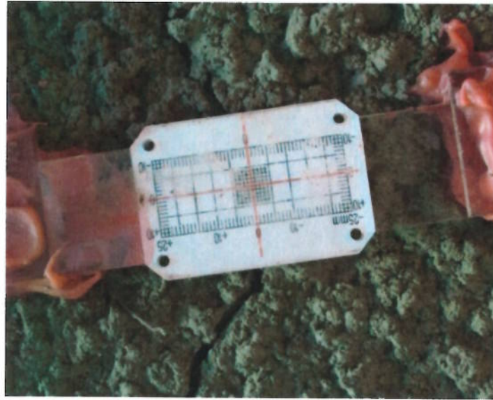
Figura 83: Ejemplo de un medidor de grietas con capacidad de indicar movimientos
