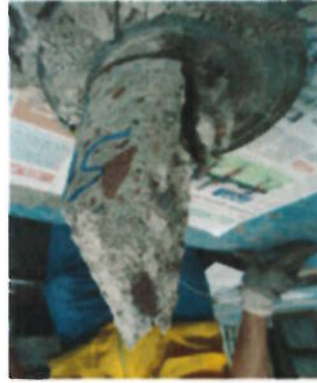
Figura 18: Ensayo de compresión simple muestra frontal capa externa Abs 0+326 Hastial sur
