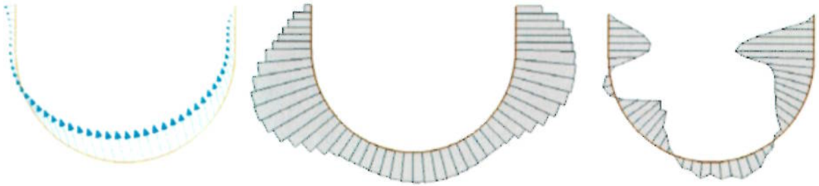
Figura 78: Diagramas típicos de sobrepeso asimétrico (izquierda: momento, centro: fuerza axial, derecha: deformación)
