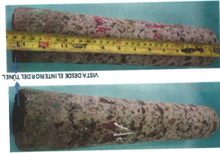
Figura 23: Núcleo extraído Abs 0+798 hastial sur capa externa (línea dos)
