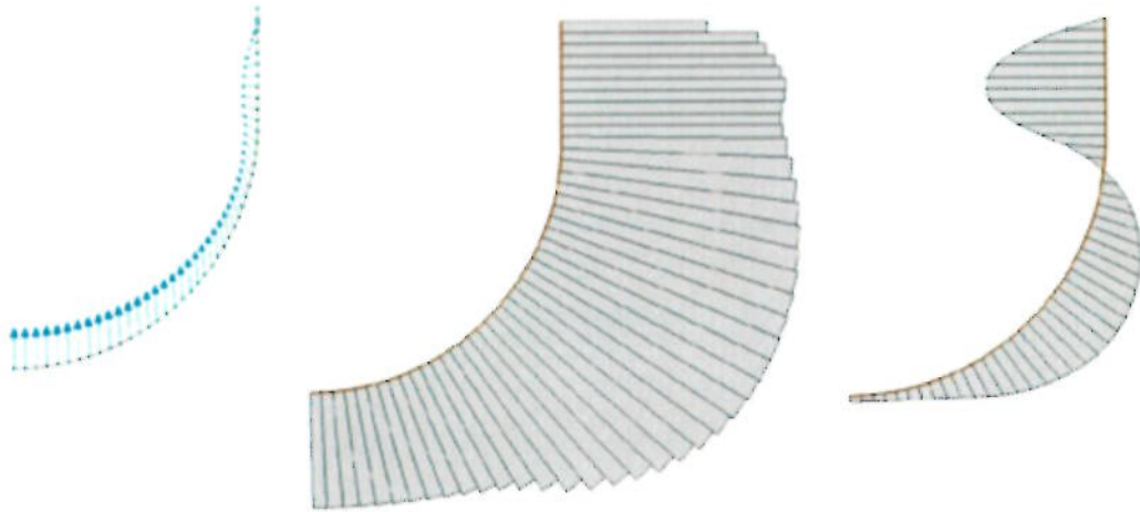
Figura 77: Diagramas típicos de sobrepesos simétricos (izquierda: momento, centro: fuerza axial, derecha: deformación)
