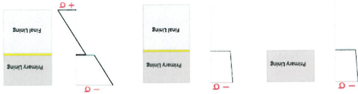
Figura 82: Esfuerzos en revestimientos combinados
