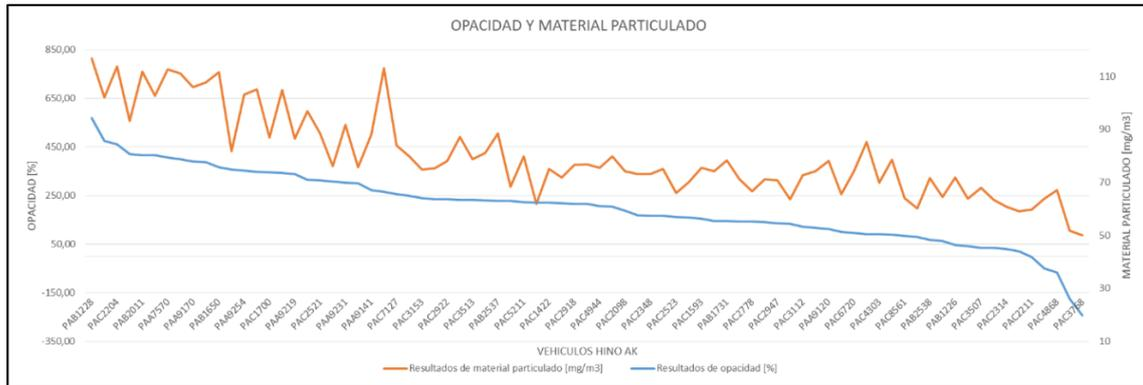
**Figura 4.** Resultados de las pruebas de opacidad y material particulado de los vehículos de muestra (Integrados) Hino AK.
