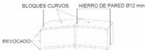
DETALLE BLOQUES CURVOS
