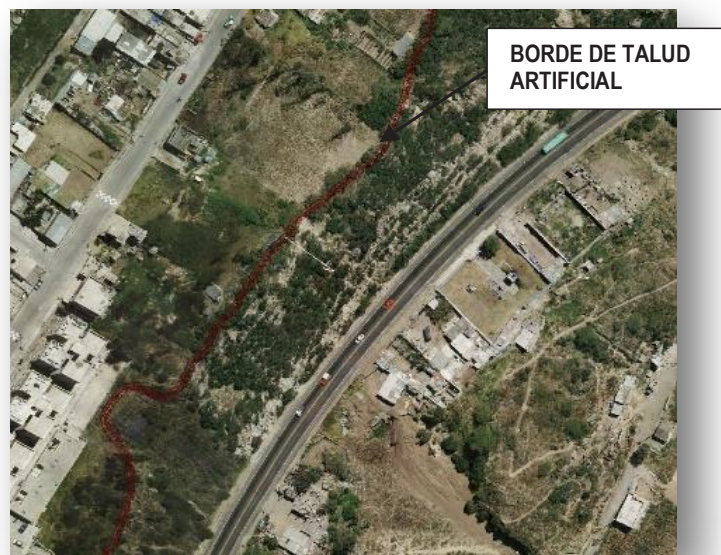
Figura 20: Implantación del borde superior de talud artificial
