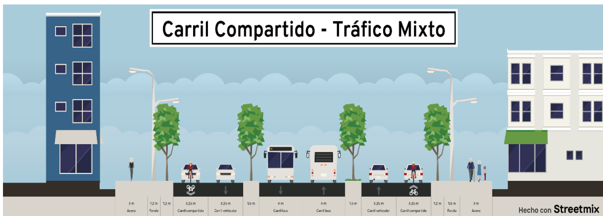
Figura 5-6. Ancho mínimo del carril unidireccional compartido con tráfico mixto
