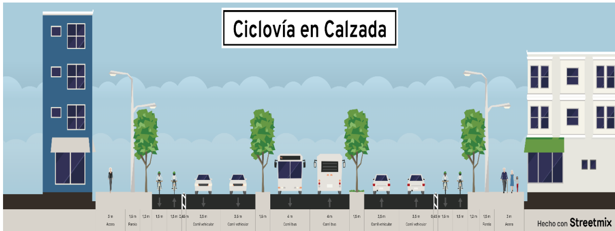
Figura 5-4. Ancho mínimo de la ciclovía bidireccional en calzada
