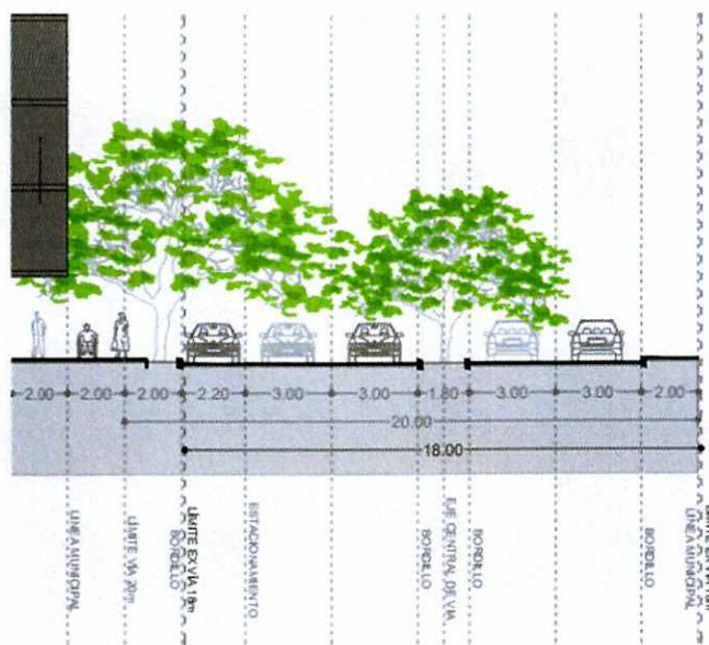
Figura No.23 Detalle sección vial de las calles: Betania
