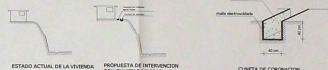
ESTADO ACTUAL DEL VIAL EN LA VEREDA DE SECTORES DONDE EXISTEN PROPOSICIÓN DE INTERVENCIÓN CON CUNETAS DE CORONACIÓN
