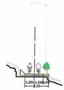
Sección vial vía ciclistica - Corte A - A' escala 1:250
