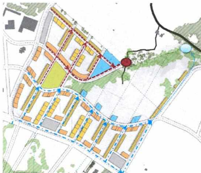
TRATAMIENTO DE AGUAS ALCANTARILLADO PARA LUEGO DESCARGA A QUEBRADA
