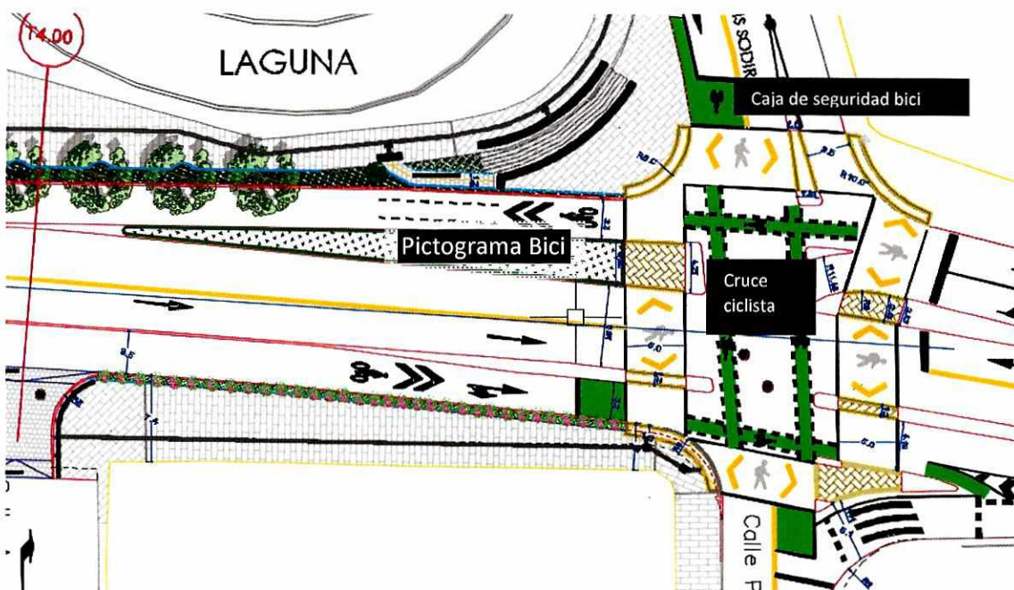
Imagen No 15.- intersección Av. Gran Colombia y Sodiro señalización de carril compartido tipo 1
