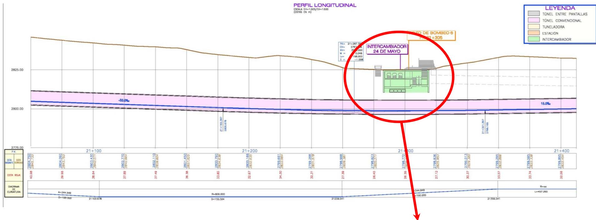
Intercambiador de 24 de Mayo por encima de colector y túnel de línea.
