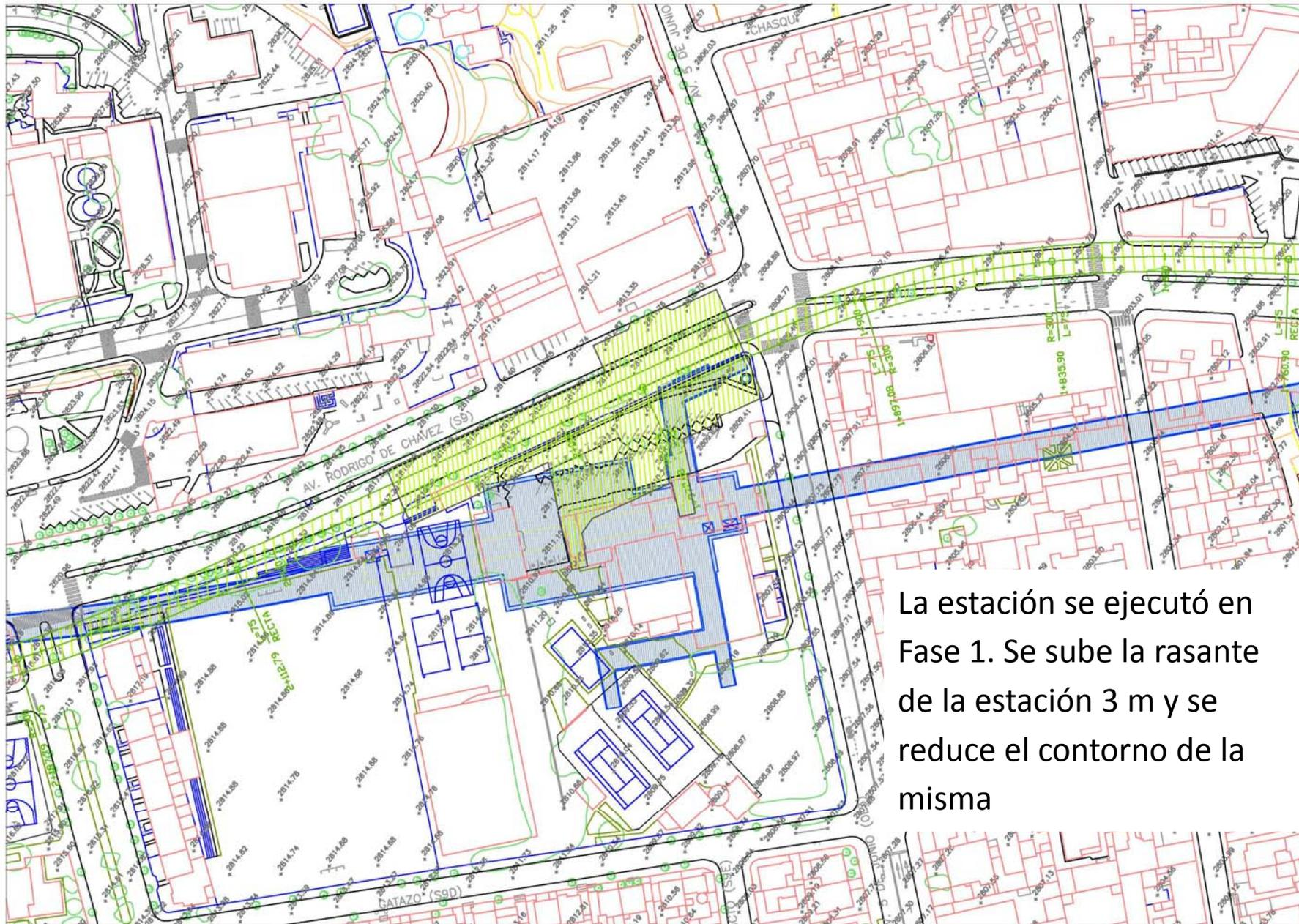
La estación se ejecutó en Fase 1. Se sube la rasante de la estación 3 m y se reduce el contorno de la misma
