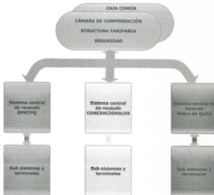
Cada subsistema de transporte opera independientemente, no obstante, todos se conectan al Administrador General del Sistema (sección verde del gráfico). En este esquema, tomado de los documentos de Diseño del SIR, se pueden observar 4 macrocomponentes principales que son:
