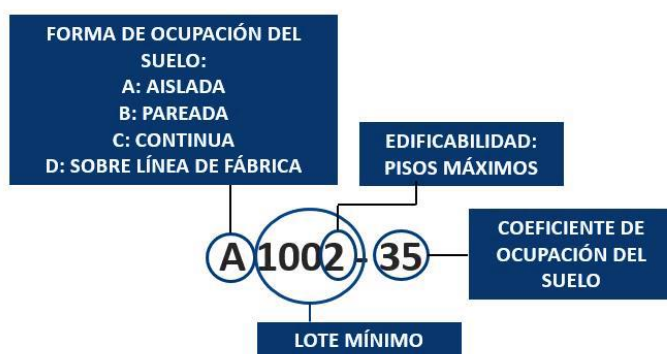
Gráfico 7.1. Esquema de lectura de los códigos de edificabilidad asignados en el PUGS
