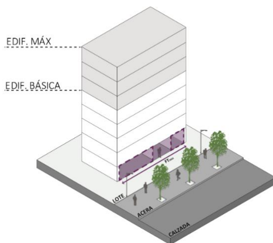
Gráfico 3.25. Esquema referencial fachadas activas en planta baja
