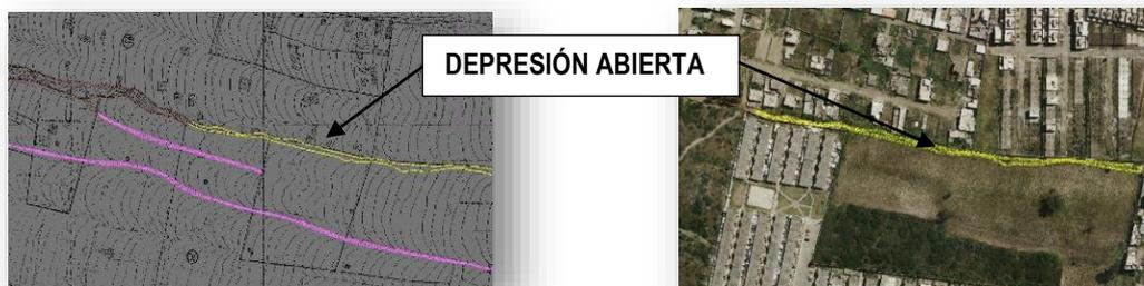
Figura 23: Implantación sobre cartografía de la depression abierta
